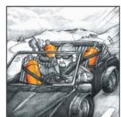
Flaschen beim Transport immer sichern. Always secure cylinders for transport, Fissate sempre le bombole durante il
