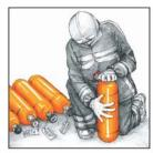
Auch bei leeren Flaschen Ventile geschlos-Also keep valves of empty cylinders closed.
